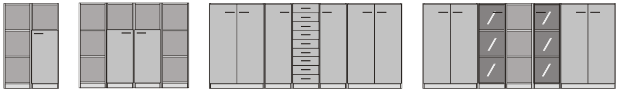
příklady skříňkových sestav (šířkový modul 400 mm)
